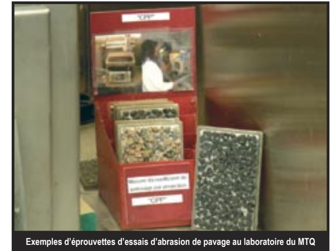
Exemples d'éprouvettes d'essais d'abrasion de pavage au laboratoire du MTQ
