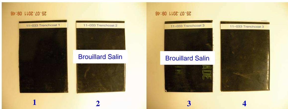
**Préparation des échantillons pour l'essai de brouillard salin:**
